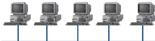
Рисунок 14.3 Шинная топология
